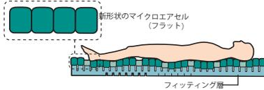
表面形状がフラットなマイクロエアセルによりマットレスに寝た際の心地よさを向上しています。また、マイクロエアセルと連動するフィッティング層が寝返りなどの動きやすさを向上しています。
